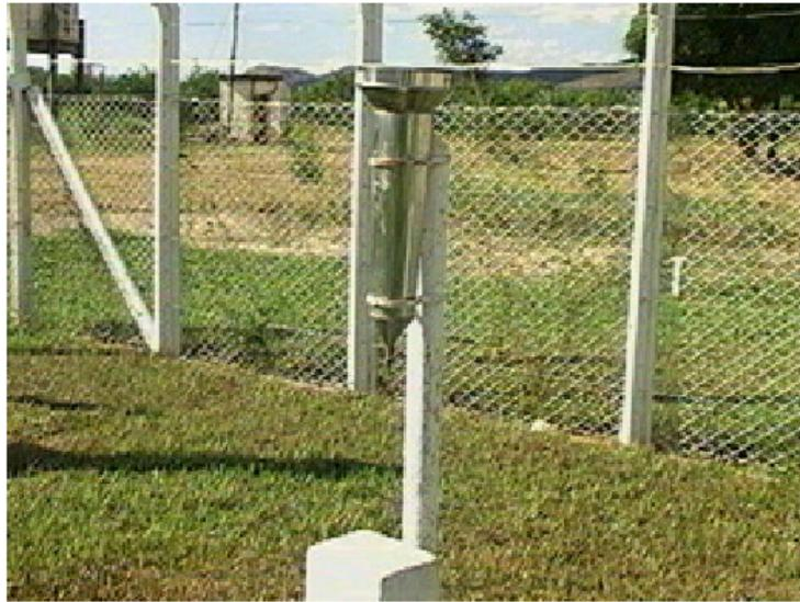
Figura 2: Pluviógrafo.
