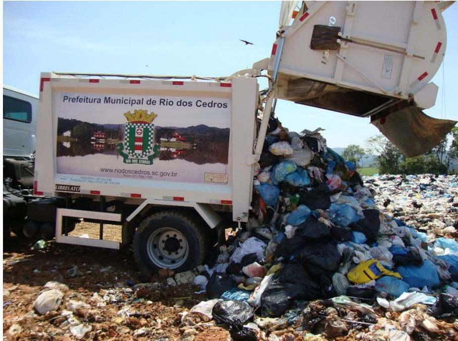
Figura 5.126: Deposição da pilha de resíduos.
