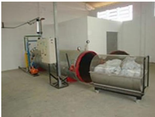
Figura 5.88: Local onde ocorre a autoclavagem dos RSS. Fonte: Recicle SC (2014)
