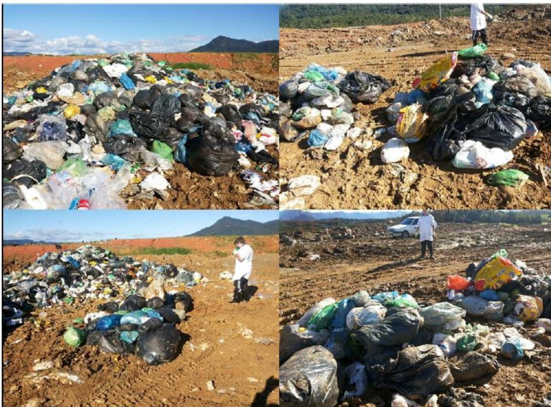
Figura 5.176. Procedimento amostral dos resíduos da coleta convencional de Timbó. Fonte: Laboprime (2015)
