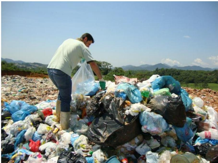
Figura 5.127: Técnico realizando a amostragem no topo da pilha de resíduos
