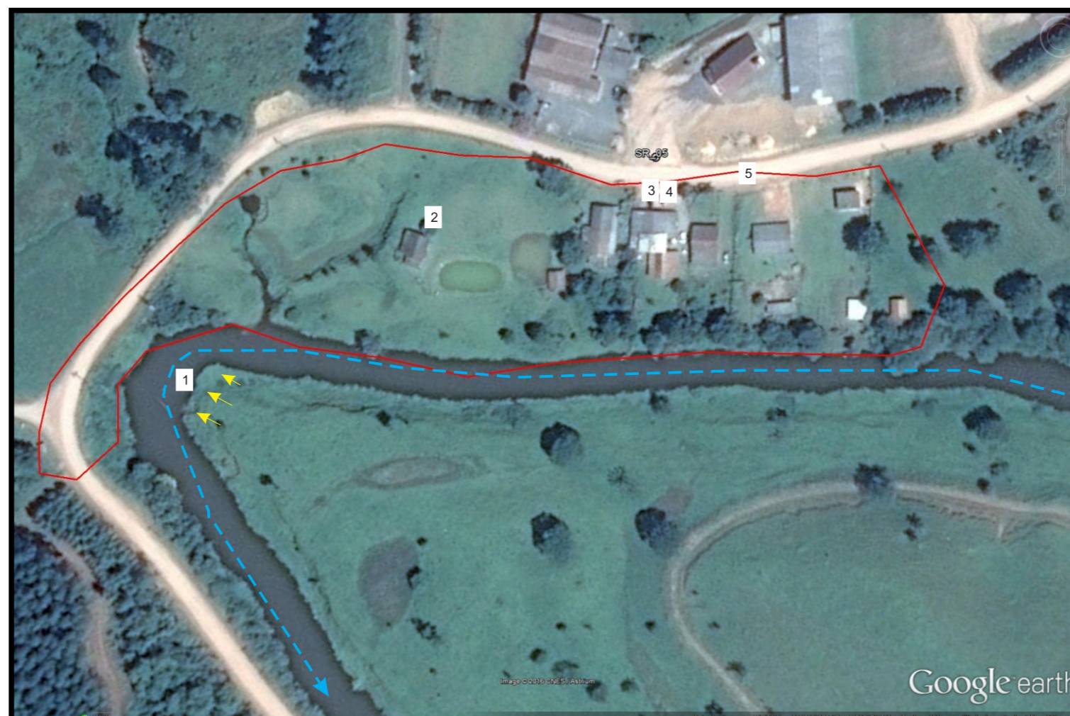
Rio dos Cedros no setor 5. Notar processo erosivo na margem.
