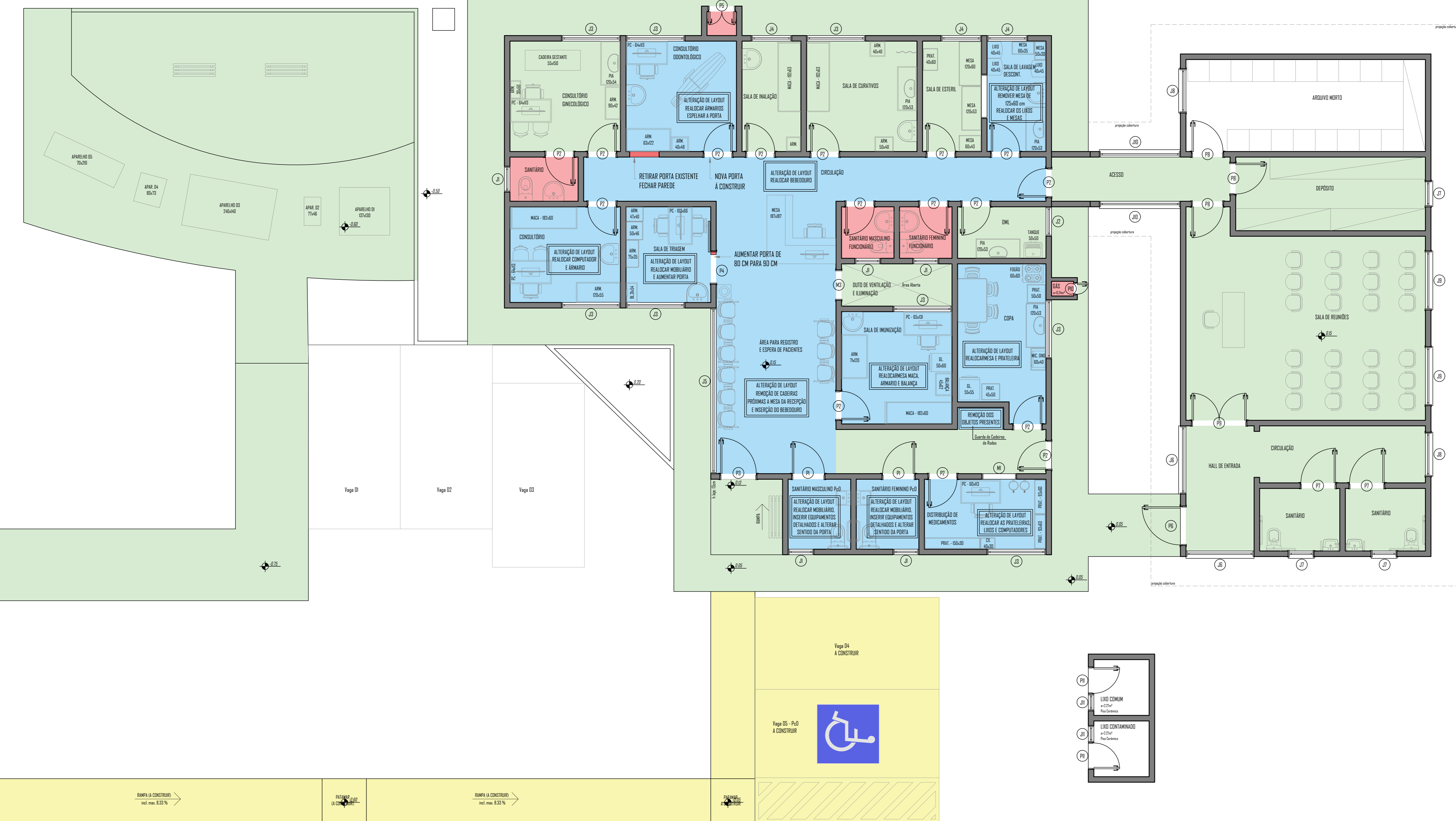
PLANTA BAIXA - ESPECIFICAÇÃO DAS ALTERAÇÕES 1/50
